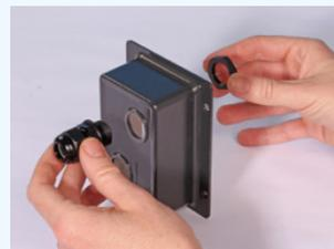
8. Utilizzare una chiave da 21 mm per serrare il pressacavo alla coppia di 2,5 Nm per garantire il grado di tenuta necessario.
