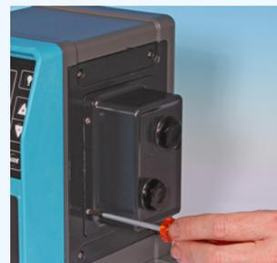
22. Utilizzare una chiave da 21 mm per serrare il tappo del pressacavo a 2,5 Nm per garantire il grado di tenuta necessario.
