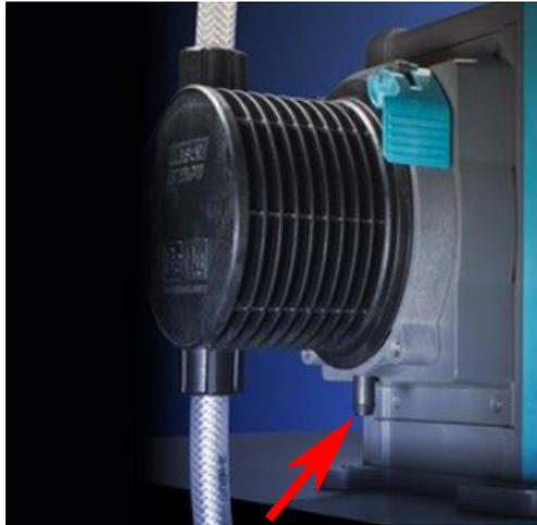
Nell'improbabile caso in cui il sensore di rilevamento delle perdite si guasti, il troppopieno di sicurezza fornisce un percorso sicuro per la fuoriuscita della miscela di fluido e lubrificante.
