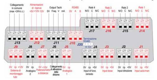
Non applicare mai l'alimentazione di rete ai terminali all'interno del modulo 720N. Applicare i segnali corretti ai terminali indicati qui di seguito. Limitare i segnali ai valori massimi indicati. Non applicare tensione su altri terminali. In caso contrario, può derivarne un danno permanente, non coperto dalla garanzia. La tensione massima sui contatti dei relè di questa pompa è di 30 V c.c.; carico massimo 30 W. Nota: adatto anche per bassa tensione: ovvero, 1
