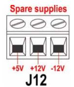
Una tensione appropriata è disponibile dove necessario su ogni connettore. Inoltre, è possibile prelevare l'alimentazione dal connettore di alimentazione di riserva (J12).
