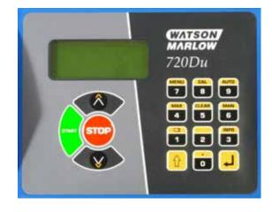
**Nota: SHIFT** consente di accedere alle funzioni sulla parte superiore dei tasti numerici. Per esempio, per accedere alla funzione **MAX** premere **SHIFT** una volta *e rilasciarlo*. Nella parte inferiore sinistra del display, viene visualizzato un simbolo indicante che con la successiva pressione del tasto **SHIFT** verrà commutata la funzione. Premere il tasto **4 (MAX)**.
