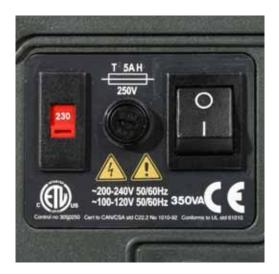
**Fusibile linea ingresso**: fusibile a cartuccia ad azione ritardata tipo T5A H 250 V 20 mm, situato in un portafusibili al centro del quadro interruttori nella parte posteriore della pompa.
