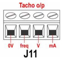
**Nota**: se l'output mA deve essere utilizzato per la lettura con un multimetro, è necessario un resistore da 250  $\Omega$  in serie.
