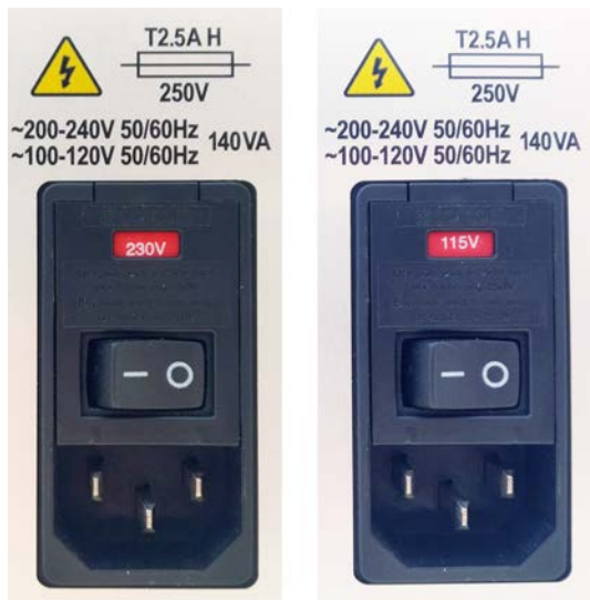
Figura 11 - Selector de tensión.
