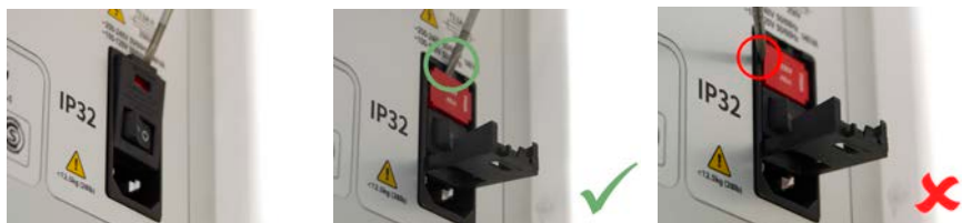
Figura 13 - Cómo quitar el soporte de fusibles
