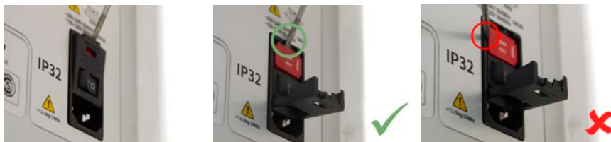
Figura 57 - Cómo quitar el soporte de fusibles
