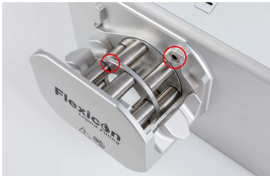
Figura 3 - Montaje y desmontaje del cabezal
