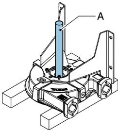
7. ロータにプラスチック製または木製のドライブピン(A)を載せます。
