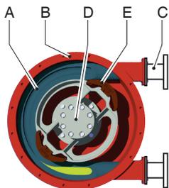
ポンプヘッドの中心部は、ポンプハウジング(B)の内側に位置する特別に構築されたホース(A)で構成されています。
