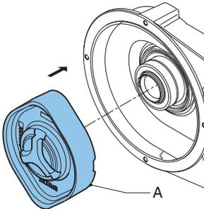
18. ロータ(A)を取り付けます。ロータは、緩い締め込みでベアリングに配置されます。ハブの保持リングが噛み合うまでロータを押し込みます。
