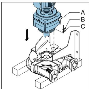
23. ポンプドライブ (A) をナット (B) とワッシャー (C) で固定します。指定されたトルク設定で締めてください。
