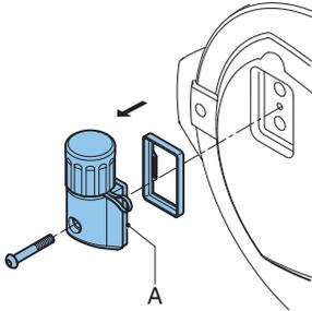
1. ポンプヘッドのカバー上の標準脱気キャップ(A)を取り外します。
