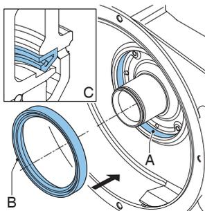
14. 新しいシールリング(B)をキャビティにそつと押し込みます。シールリングは、開いた側がポンプカバーの方を向く正しい向き(C)で取り付ける必要があります。取り付けを簡単にするために必要な場合は、キャビティ部位(A)にわずかにオイルを塗布してください。
