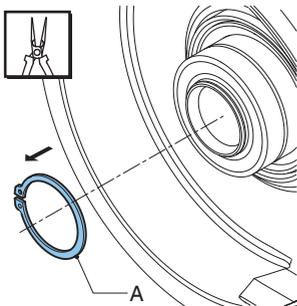
10. 適切な工具を使用して保持サークリップ(A)を外します。
