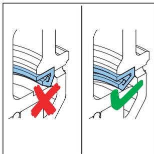
19. ロータが手で簡単に回転できるか確認します。できる場合は、次の2つのステップを省略します。回転のために過度の力が必要な場合は、シールのリップがロータのシール部に適切に位置決めされていません。次のステップに進んでください。
