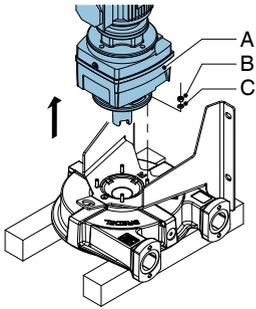
6. ナット (B)ワッシャー(C)、ポンプドライブ(A)を取り外します。
