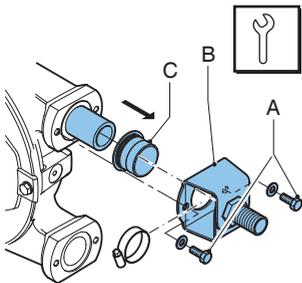
7. ブラケット (B) の保持ボルト (A) を緩め、ボルトを外します。
