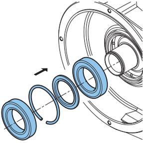
16. (新しい) ベアリングの内側リングとハブのシートにわずかに油を注ぎます。ベアリングとリングを取り付けてください。ベアリングは、わずかな締め込みでハブに配置されています。プレス工具を使用してハブのベアリングを押し込みます。
