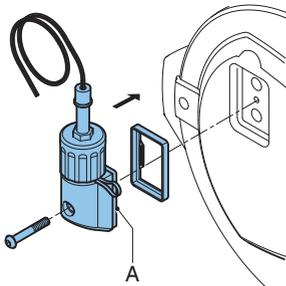
2. 高レベルフロートスイッチでブリーザ(A)を取り付けます。指定されたトルクでボルトを締めてください。
