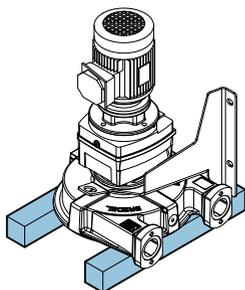
5. ポンプをブロックに置きます。ブロック間のスペースがロータが落下するのに十分な幅であることを確認してください。
