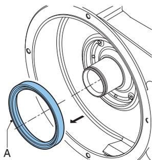
13. シールリング(A)を取り外します。ポアを清掃および脱脂します。
