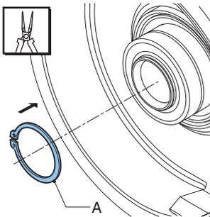
17. ロータの保持サークリップ(A)に損傷の兆候がないか確認し、必要に応じて交換します。保持サークリップ(A)を取り付けます。この場合適切なツールを使用してください。
