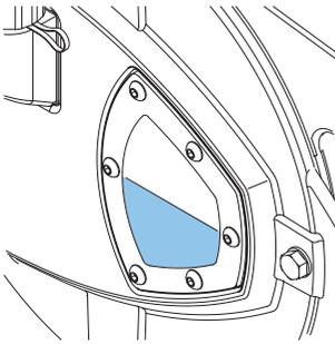
4. 潤滑剤レベルが検査窓の レベルラインより上になるまで注ぎ続けてください。脱気キャップを戻します。
