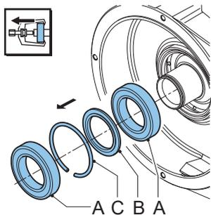
11. 適切な工具を使用して、ベアリング(A)、スペーサーリング(B)、保持リング(C)を取り外します。
