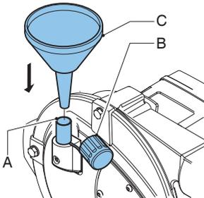
3. ポンプハウジングは、脱気(A)を介して潤滑剤で充填することができます。この目的のために、脱気キャップ(B)を取り外し、内に漏斗(C)をセットします。潤滑剤を漏斗を使ってポンプハウジングに注ぎます。
