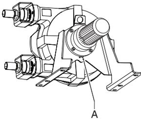
この機能を、漏れゾーン (A) といいます。ポンプの背面に見える潤滑剤の滴は、シール不良の可能性を示しています。結果的な損傷を避けるためには、ポンプを停止し、ポンプヘッドとギアボックスの潤滑剤レベルをチェックする必要があります。破損したシールは交換する必要があります。
