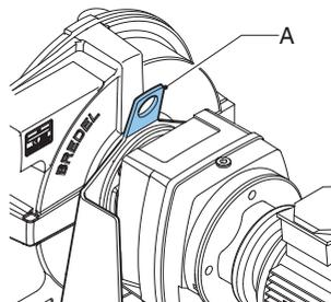
ホースポンプ (ポンプヘッド、ギアボックスおよびモータ) は、適切に定格を有するストラップまたはスリング (A) を使用して吊り上げる必要があります。
