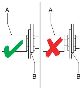
8. ホース(A)がブラケット(B)にしっかりと押し付けられるようにロータを回転させます。
