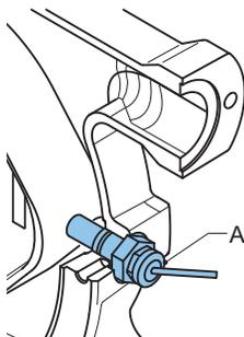
ポンプの回転信号を「インテリジェント」システムにフィードバックするために、ポンプにセンサ(A)を設けることができます。このセンサは2つのポートの間に取り付けられています。
