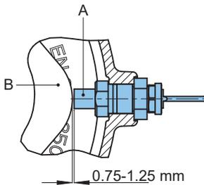
センサ(A)は必ずロータ(B)に対して0.75 ~ 1.25 mmのオフセットで調整してください。
