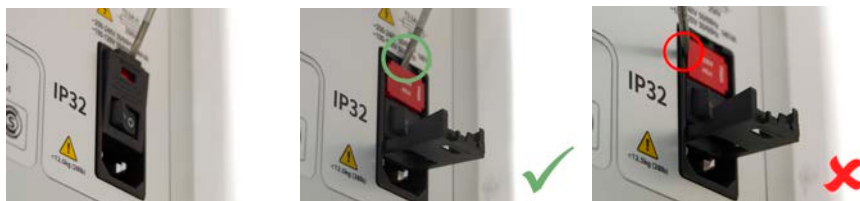
Figure 13 - Méthode de retrait du porte-fusible
