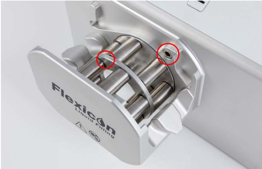
Figure 3 - Montage et démontage de la tête de pompe
