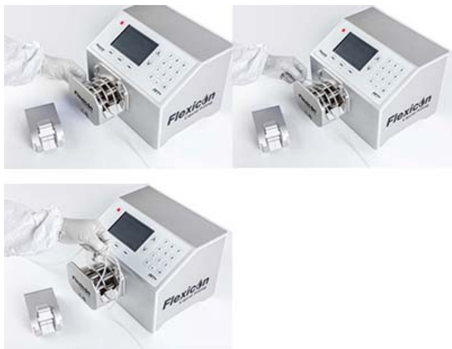
Figure 8 - Retrait du tube de la tête de pompe
