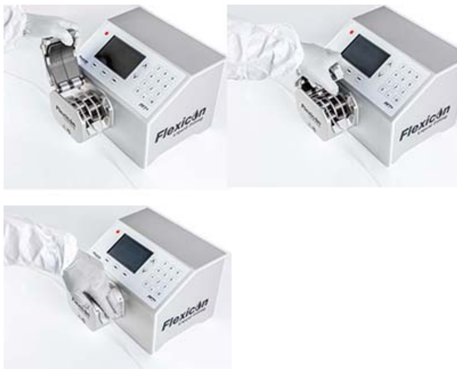
Figure 10 - Fermeture de la tête de pompe
