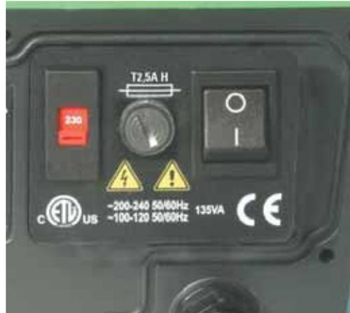
**Absicherung der Eingangsleitung:** Träge Sicherung vom Typ T2,5A H (250 V / 20 mm) in einem Sicherungshalter in der Mitte der Schalterabdeckplatte hinten an der Pumpe.
