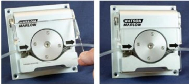
10. Raccordez le tube péristaltique au montage de tube conformément à la procédure de votre entreprise.
