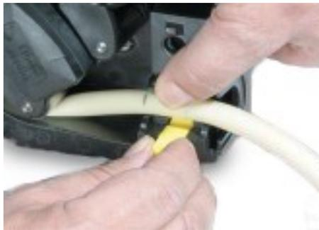
15. Dégagez l'embrayage du rotor en appuyant au maximum sur le bouton d'embrayage jaune du côté moyeu de rotor et en tournant le moyeu de quelques degrés tout en maintenant le bouton d'embrayage enfoncé. Le rotor peut maintenant tourner indépendamment du réducteur et du moteur sur un tour entier. Si l'embrayage est réengagé avant que la pose du tube ne soit terminée, enfoncez à nouveau le bouton d'embrayage et tournez le rotor de quelques degrés.
