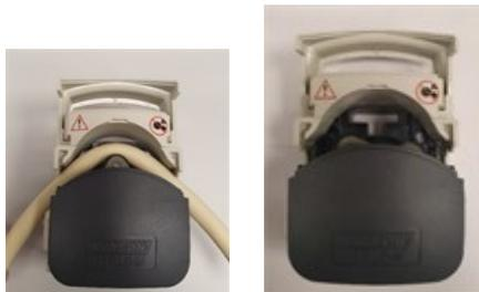
6. Abaissez le capot en position complètement fermée, afin que le tube soit automatiquement tendu correctement.
