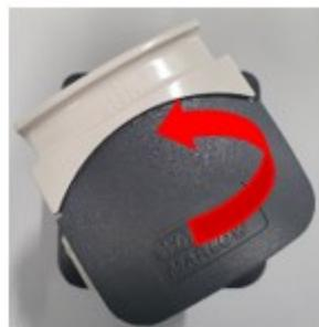
3. Placez la nouvelle tête de pompe sur la plaque de fixation et tournez dans le sens des aiguilles d'une montre jusqu'à ce que le clip remonte et enclenche la tête de pompe.
