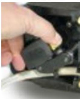
8. Positionnez l'élément de tube le long du stator de la tête de pompe en tournant le rotor autant que nécessaire.
