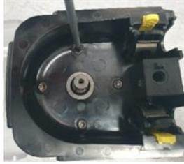
7. Fixez le hub du rotor en soulevant le capot anti-poussière et en installant la vis de fixation.
