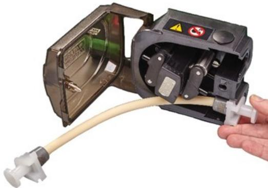
5. Dégagez l'embrayage du rotor en appuyant au maximum sur le bouton d'embrayage jaune du côté moyeu de rotor et en tournant le moyeu de quelques degrés tout en maintenant le bouton d'embrayage enfoncé. Le rotor peut maintenant tourner indépendamment du réducteur et du moteur sur un tour entier. Si l'embrayage est réengagé avant que la pose du tube ne soit terminée, enfoncez à nouveau le bouton d'embrayage et tournez le rotor de quelques degrés.
