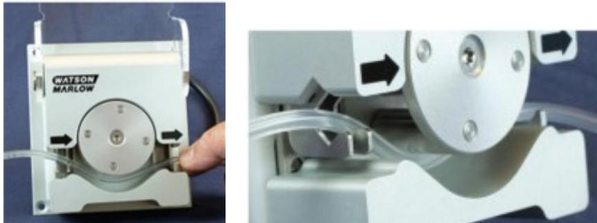
8. Abaissez le capot en position complètement fermée, afin que le tube soit automatiquement tendu correctement.
