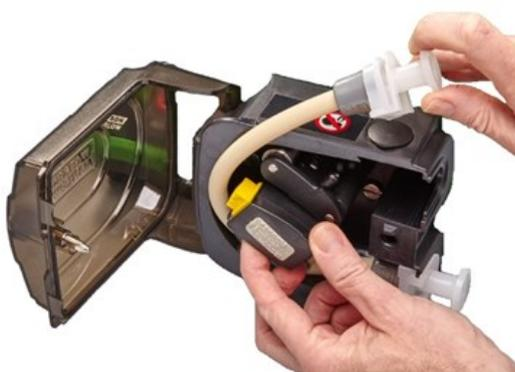
9. Placez l'autre connecteur de l'élément de tube dans le corps supérieur. Assurez-vous que l'élément de tube n'est pas vrillé et qu'il repose au centre entre les galets.
