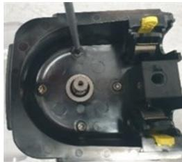
5. Déposez la tête de pompe de la plaque de fixation et remplacez-la par une nouvelle tête de pompe.
