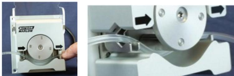
6. Abaissez le capot en position complètement fermée, afin que le tube soit automatiquement tendu correctement.
