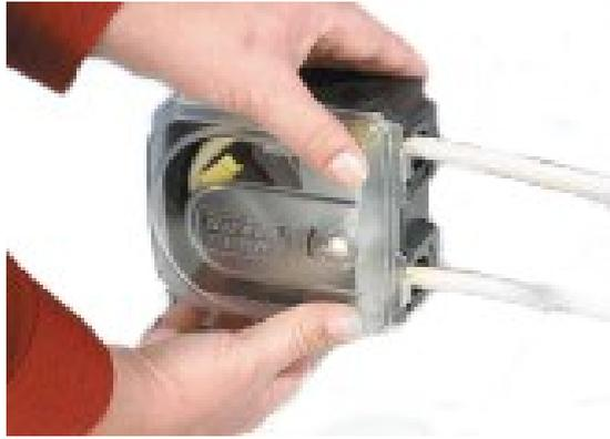
20. Raccordez à nouveau le tube péristaltique au montage de tube conformément à la procédure de votre entreprise.
