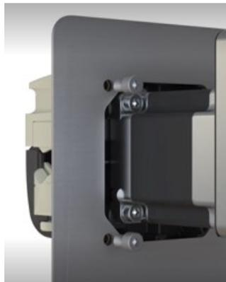
5. Serrez au couple de 4,6 Nm les 4 vis de fixation en utilisant un schéma de serrage alterné.
