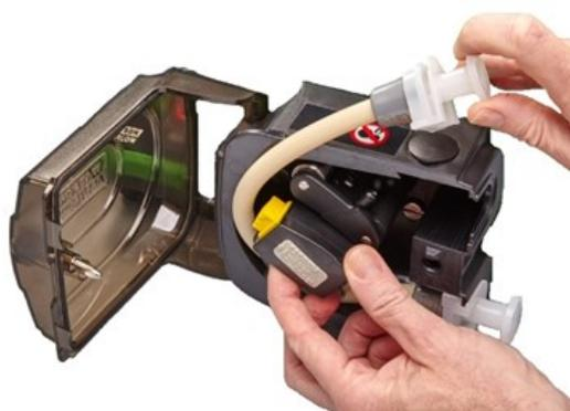
7. Placez l'autre connecteur de l'élément de tube dans le corps supérieur. Assurez-vous que l'élément de tube n'est pas vrillé et qu'il repose au centre entre les galets.
