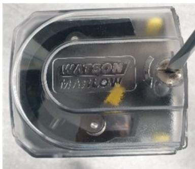
5. Ouvrez complètement le capot pour créer un dégagement maximum pour les orifices du tube.
