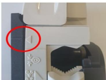
4. Tournez la molette de réglage sur l'assemblage de la pince afin que l'épaisseur de paroi du tube requise s'aligne avec la taille de diamètre du tube nécessaire. Tournez la molette de réglage dans le sens horaire pour l'abaisser et dans le sens antihoraire pour l'élever.
