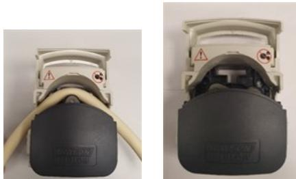
8. Abaissez le capot en position complètement fermée, afin que le tube soit automatiquement tendu correctement. Vérifiez que le tube soit dans la position illustrée. Ne pas ajouter de tension supplémentaire au tube.
