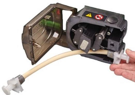
7. Dégagez l'embrayage du rotor en appuyant au maximum sur le bouton d'embrayage jaune du côté moyeu de rotor et en tournant le moyeu de quelques degrés tout en maintenant le bouton d'embrayage enfoncé. Le rotor peut maintenant tourner indépendamment du réducteur et du moteur sur un tour entier. Si l'embrayage est réengagé avant que la pose du tube ne soit terminée, enfoncez à nouveau le bouton d'embrayage et tournez le rotor de quelques degrés.
