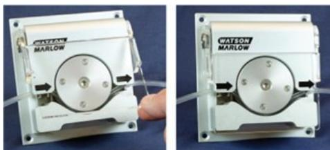
8. Raccordez le tube péristaltique au montage de tube conformément à la procédure de votre entreprise.
