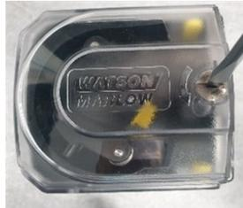
3. Déposez le hub du rotor en soulevant le capot anti-poussière et en retirant la vis de fixation.
