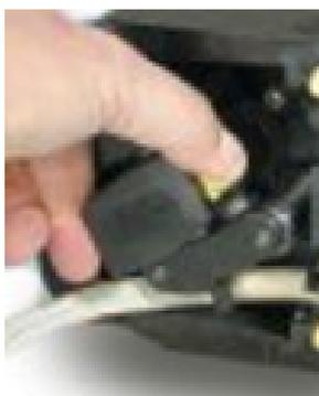
6. Positionnez l'élément de tube le long du stator de la tête de pompe en tournant le rotor autant que nécessaire.
