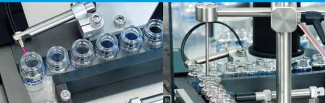
FF20是一种桌面型旋转式走瓶系统,用于配合Flexicon蠕动分装泵或滑片分装泵,实现液体或乳脂类产品分装操作的自动灌装。
