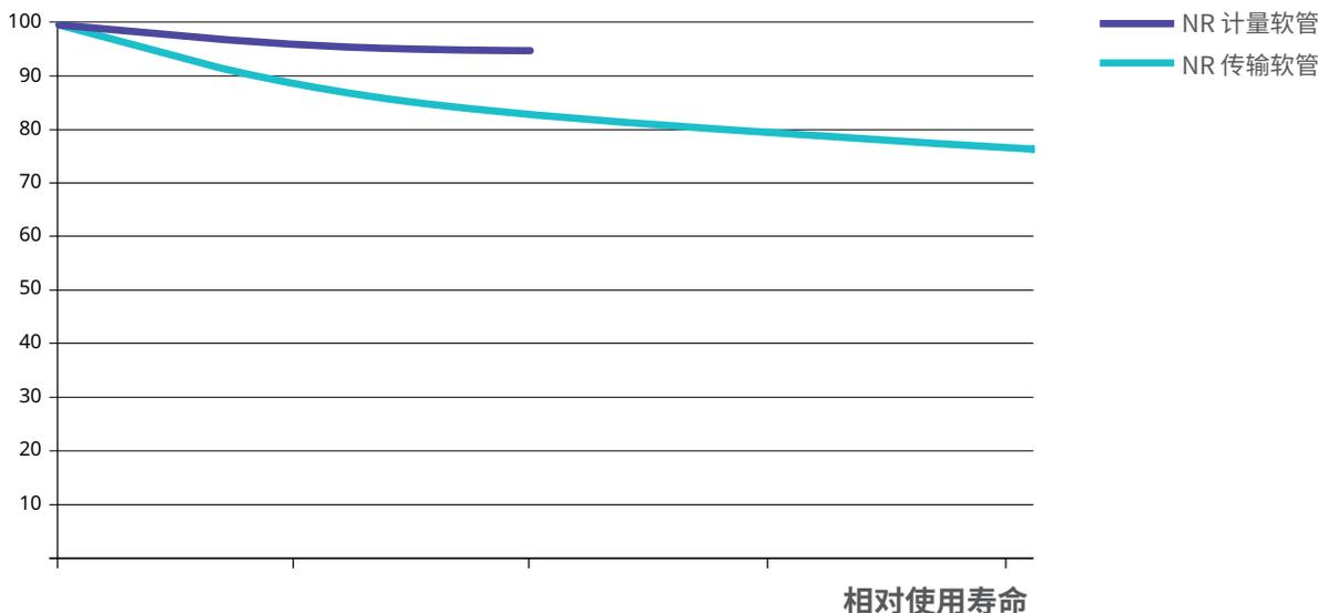
典型性能测试条件：在 18°C (64°F)、5 bar (73 psi) 和 50rpm 的条件下泵送水
