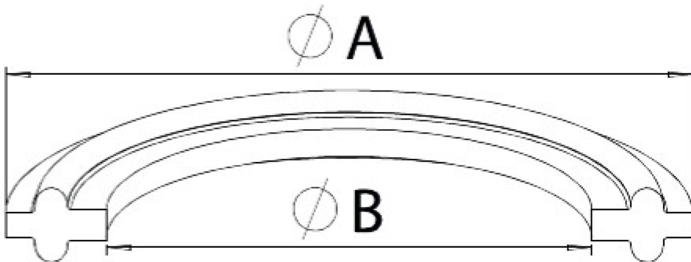
**BioPure高純度プラチナ硬化シリコーンガスケット - レーザーエッチング済み**
