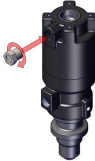
13. Vissez la vis à épaulement à l'intérieur. Faites pression entre le compresseur et le cylindre pneumatique pour être sûr que les parties plates restent alignées.
