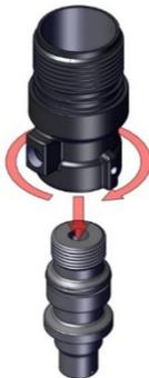
3. Vissez les vis de réglage dans l'enveloppe supérieure et serrez.
