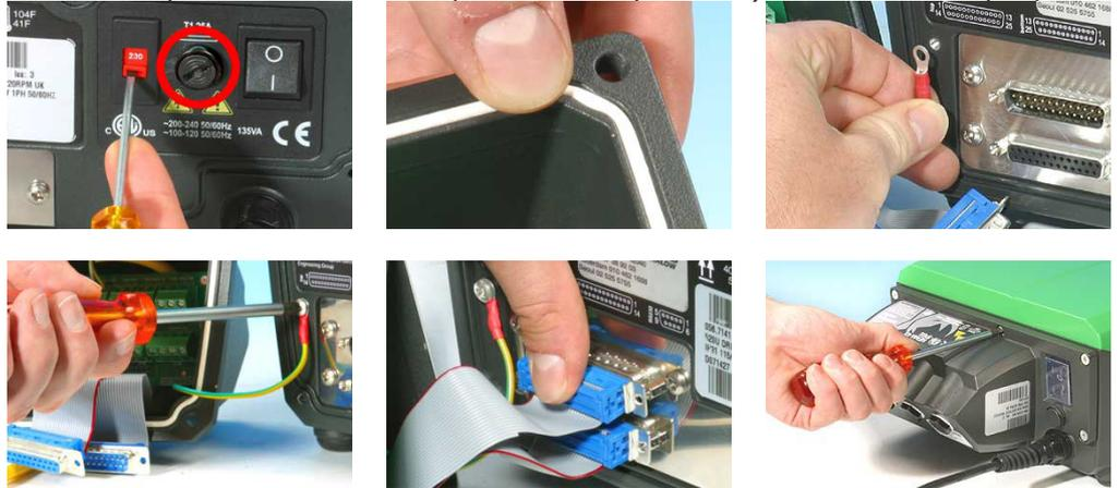
commutation n'a pas besoin d'être remplacé. Vérifiez que le commutateur de sélection de tension est réglé correctement pour l'alimentation.
