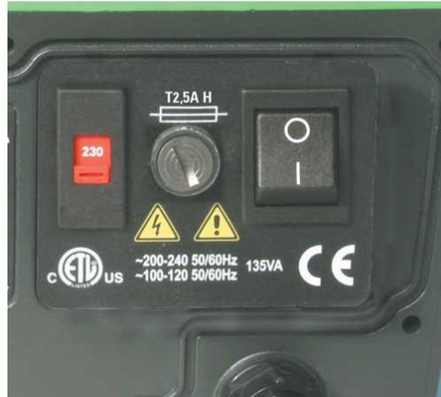
**Fusible de ligne d'entrée** : Fusible à temporisation de type T2,5A H 250 V 20 mm, situé dans le porte-fusible au centre de la plaque de commutation à l'arrière de la pompe.
