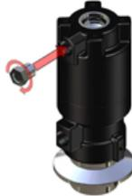
13. Infilare la vite di spalla nell'insieme. Premere l'albero contro l'alloggiamento pneumatico per assicurare che le superfici piane dell'albero rimangano allineate.
