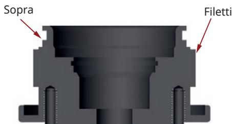
3. Con delle pinze per anelli elastici, rimuovere l'anello elastico dal centro della parte superiore.
