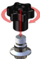
4. Inserire l'O-ring nella scanalatura del volantino.
