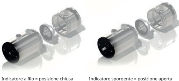
4. Avviare la fonte d'aria e aprire completamente l'attuatore, in modo tale che il diaframma sia arretrato rispetto alla sede della valvola. L'indicatore di posizione dovrebbe sporgere dal terminale dell'attuatore. Questo fa arretrare il diaframma per consentire una salda compressione della guarnizione dello stantuffo.
