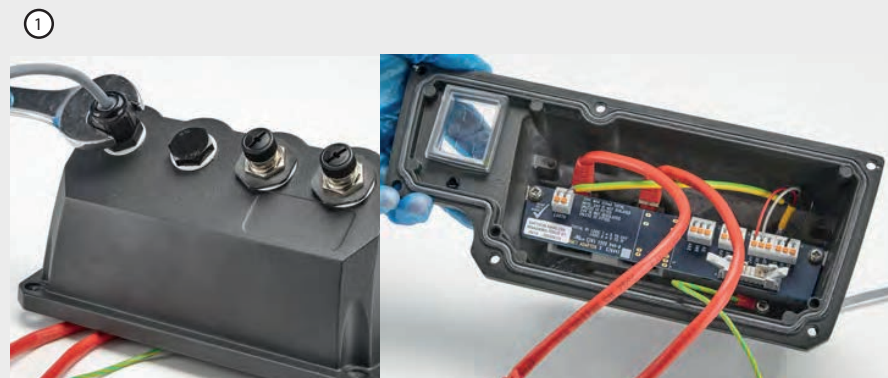
Figure 10 - Erdungsschirmung der Steuerleitungen am PROFINET®NEMA-Modul
