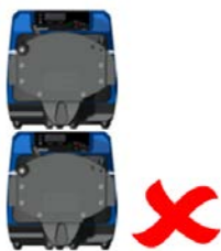
Figura 2 - Apilado de bombas
