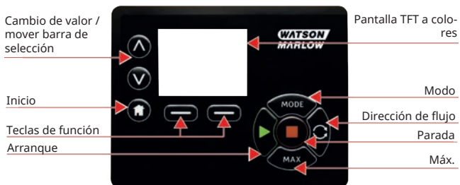
Figura 4 - Distribución del teclado e identificación de teclas
