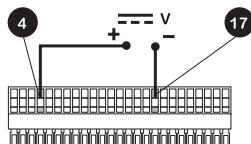
For spenning moduser kan en stabil variabel likestrømkilde brukes sammen med et voltmeter for likestrøm (maksimum 30V likestrøm). Kretsimpedans 100 kOhm. Polaritet satt for ikke-invertert respons. Reverser polariteten for invertert respons.
