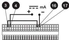
For strømstyrke moduser kan den samme likestrømkilden brukes sammen med et milliamperemeter for likestrøm (maksimum 32 mA). Kretsimpedans 250 Ohm. Polaritet satt for ikke-invertert respons. Reverser polariteten for invertert respons.
