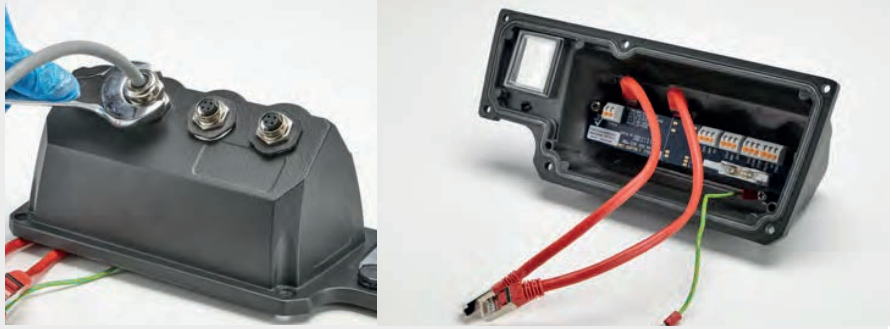
GF: 图 1 -对EtherNet/IP™ NEMA 模块的控制电缆进行接地屏蔽
