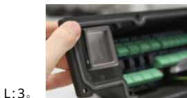
GF: 图 5 - 电压选择开关
