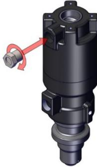
13. Rosqueie o parafuso de cabeça cilíndrica no conjunto. Pressione o compressor em direção ao cilindro pneumático para garantir que os planos do eixo permaneçam alinhados.
