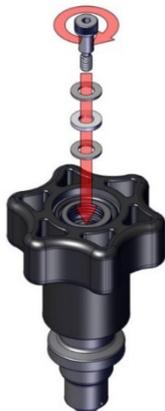
6. Instale a tampa sobre o parafuso usando uma chave de fenda com ponta spanner nº 14.
