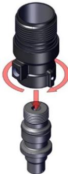
3. Rosqueie os parafusos de fixação na carcaça superior e aperte.
