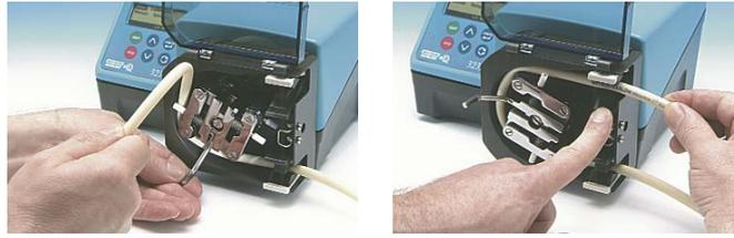
Quando a mangueira deu a volta na pista da mangueira, encaixe a outra extremidade da mangueira na presilha. Verifique se a mangueira foi encaixada naturalmente na pista para melhor vida útil da mangueira. Solte as presilhas e ajuste a mangueira se estiver frouxa, torcida ou estendida.
