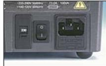
O seletor de tensão é montado na placa do interruptor na parte traseira da bomba. Posicione o seletor de tensão em 115 V para alimentação de 100-120 V 50/60 Hz ou em 230 V para alimentação de 200-240 V 50/60 Hz. Sempre verifique o interruptor do seletor de tensão antes de conectar à fonte de alimentação.
