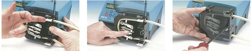
As presilhas da mangueira podem servir para mangueiras de diâmetros variados empurrando ou puxando as barras dentro da presilha. Configure as presilhas para aplicar o mínimo de pressão necessária à mangueira.
