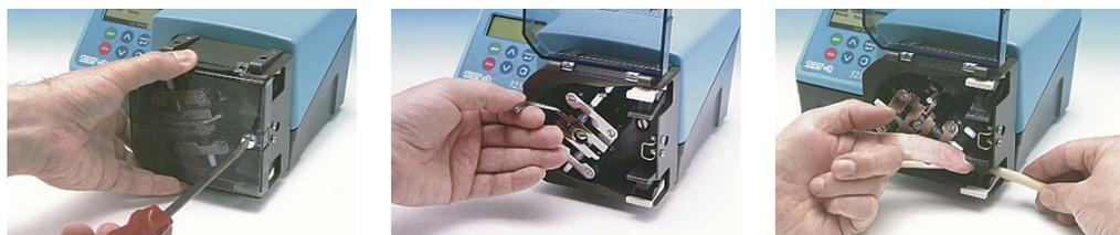
O rotor tem roletes-guia da mangueira que empurram a mangueira dentro do cabeçote durante a colocação. Gire o rotor com cuidado até que as guias da mangueira peguem a mangueira. Continue a girar o rotor e alimente a mangueira entre as guias.
