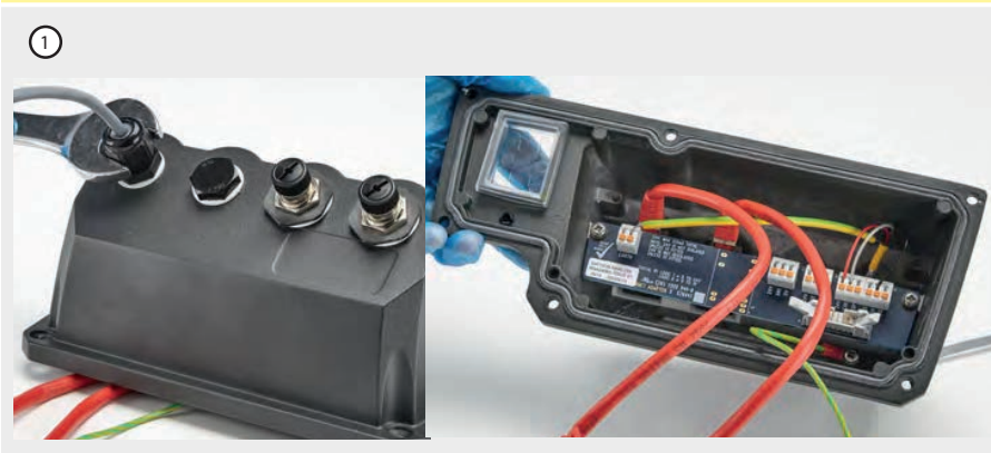
rys. 10 - Ekranowanie uziemienia przewodów sterowania wEtherNet/IP™ module NEMA
