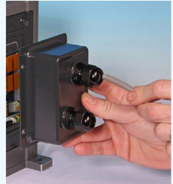
10. Inserte el cable de control en el prensaestopas flojo.
