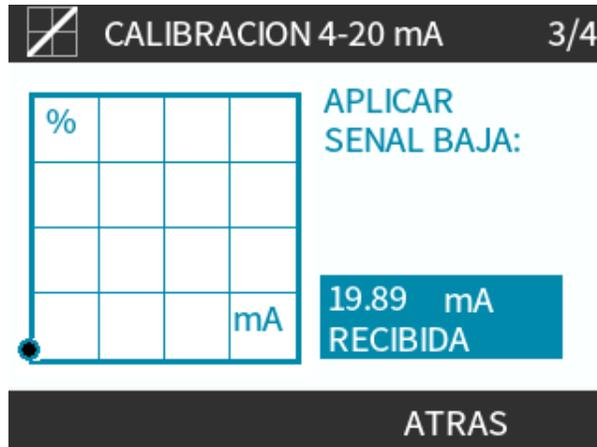
Después de ingresar todos los ajustes, aparece la pantalla de confirmación de la calibración:
