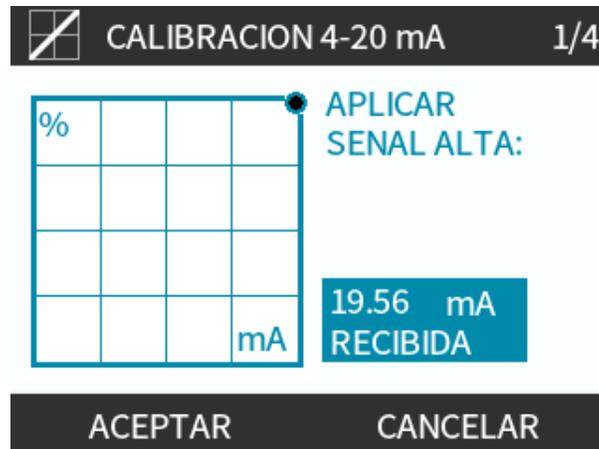
Configuración de la calibración de caudal alto
