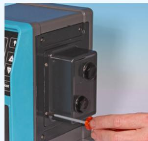
22. Con una llave de 21 mm, apriete la tapa del prensaestopas hasta 2,5 Nm, para garantizar el índice de protección contra la penetración.
