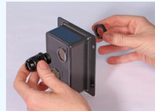
8. Con una llave de 21 mm, apriete el prensaestopas hasta 2,5 Nm, para garantizar el índice de protección contra la penetración.
