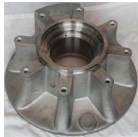
Bagsiden af det bageste pumpehus og vist, hvor den bageste tætning i systemet med mekanisk dobbelttætning skal monteres.
