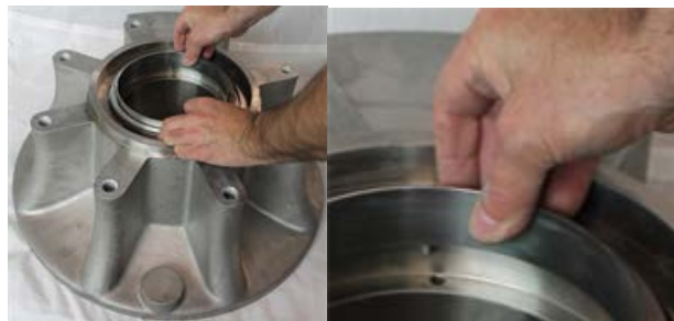
Korrekt monteret fjederenhed bagest i det bageste pumpehus.
