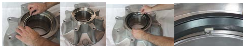
Korrekt monteret fjederenhed bagest i det bageste pumpehus.
