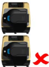
Figura 2 - Apilado de bombas
