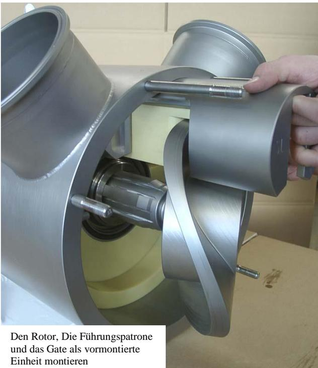
Den Rotor, Die Führungspatrone und das Gate als vormontierte Einheit montieren
