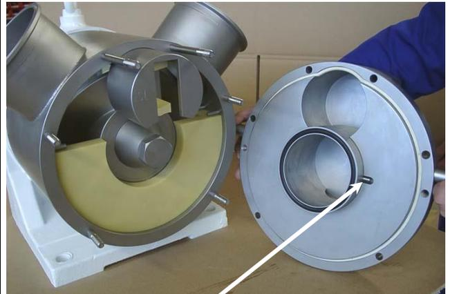
Der Stift des Frontlagers muss in die Aussparung des Frontgehäuses
