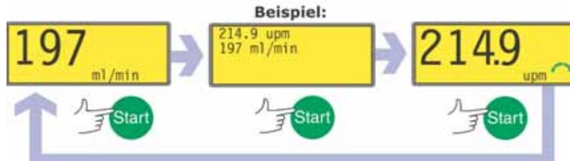
Falls die Pumpe läuft, wenn die Taste **START** gedrückt wird, wechseln die Angaben im Handbedienungs-Hauptbildschirm von Umdrehungen pro Minute zu Fördermenge in Millilitern pro Minute (mit einem Warnbildschirm, falls die Fördermenge nicht kalibriert wurde und dies der erste Arbeitszyklus seit dem Einschalten ist) und schließlich zu U/min und Fördermenge. Siehe 16 *Fördermengenkalibrierung*.
