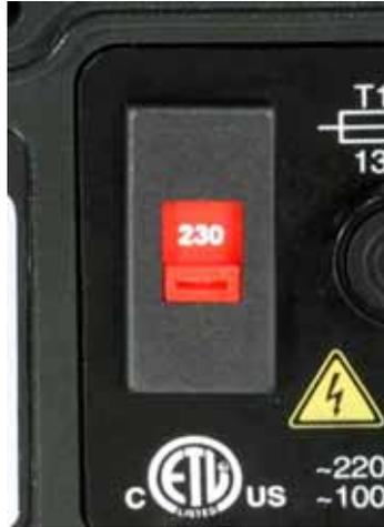
Stellen Sie den Spannungswahlschalter entweder auf 115 V (Wechselspannungen von 100-120 V bei 50/60 Hz) oder auf 230 V (Wechselspannungen von 200-240 V bei 50/60 Hz) ein. Kontrollieren Sie vor dem Anschließen der Netzstromversorgung immer den Spannungswahlschalter.
