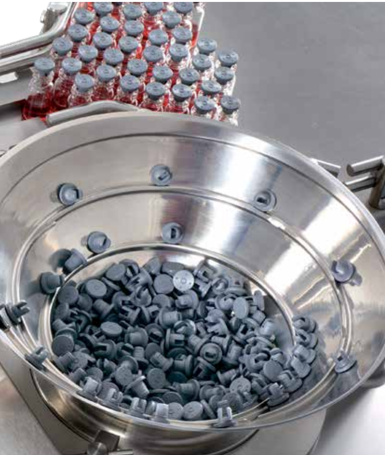
Tamponamento com tampões de 13 mm a 20 mm sem necessidade de peças adicionais
