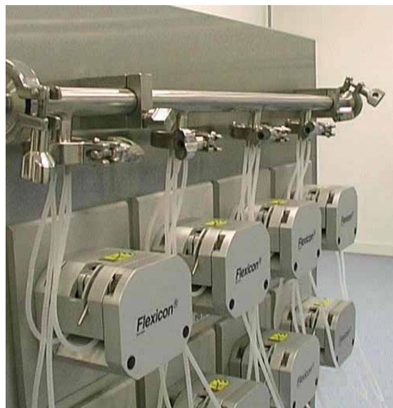
São fornecidas soluções customizadas (Trolleys) para integração em linhas novas ou já existentes com até dezesseis envasadoras peristálticas
