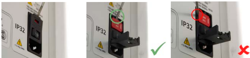
Afbeelding 13 - Hoe de zekeringhouder te verwijderen
