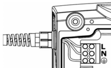
Se il cavo di alimentazione non è adeguato all'installazione, può essere sostituito. Questa operazione può essere eseguita con il modulo 520N in posizione o, dopo che è stato smontato, come indicato qui di seguito per chiarezza.
