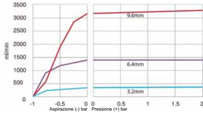
Elemento Marprene TM , 2-4 bar (30-60psi), 200 giri/min, rotazione in senso antiorario
