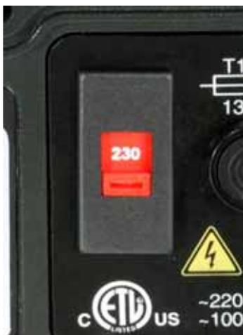
montato sul quadro interruttori sulla parte posteriore della pompa, protetto dall'acqua grazie al modulo 520N. Per consentire l'accesso al quadro interruttori, occorre smontare il modulo. Vedere 17 *Smontaggio e rimontaggio del modulo 520N*. Impostare il selettore di tensione su 115 V per alimentazioni a 100-120 V 50/60 Hz o su 230 V per alimentazioni a 200-240 V 50/60 Hz. Controllare sempre il selettore di tensione prima del collegamento all'alimentazione elettrica.
