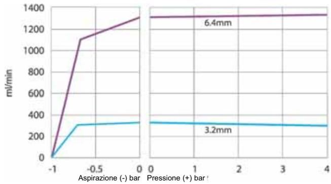
Elemento Sta-Pure , 2-4 bar (30-60psi), 200 giri/min, rotazione in senso antiorario
