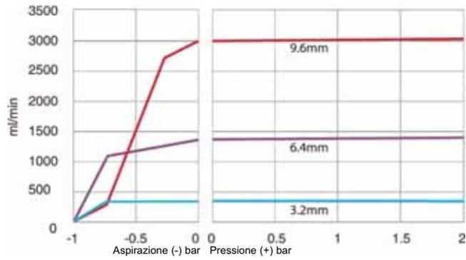
Elemento Sta-Pure , 0-2 bar (0-30psi), 200 giri/min, rotazione in senso antiorario
