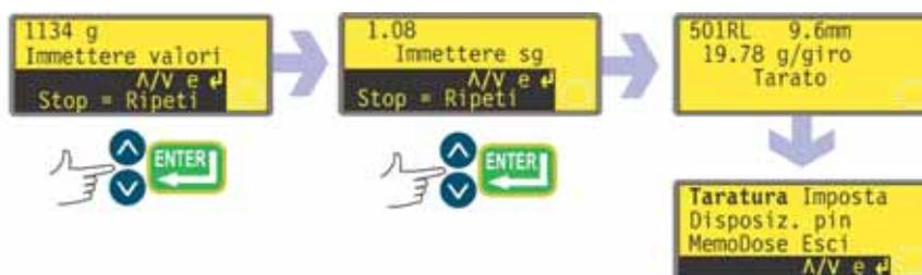
**Nota:** se la pompa è stata impostata in modo da visualizzare la portata in unità di massa (vedere 18.8 *Unità di portata*), come in questo esempio, viene visualizzata una schermata che consente di confermare il peso specifico del fluido usato subito prima di premere per l'ultima volta **ENTER**.
