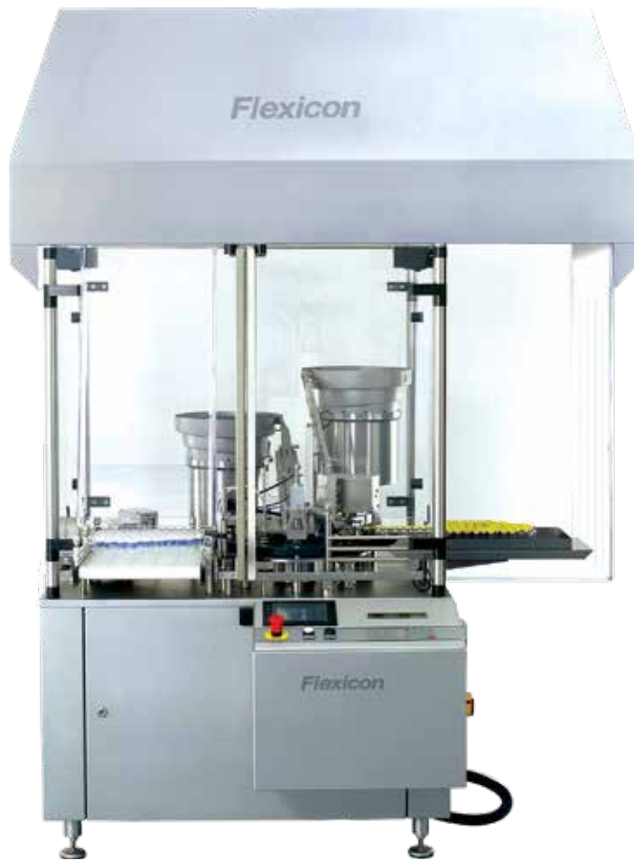
Ovenfor: En FMB210, der er installeret i et laminar air flow-skab.
