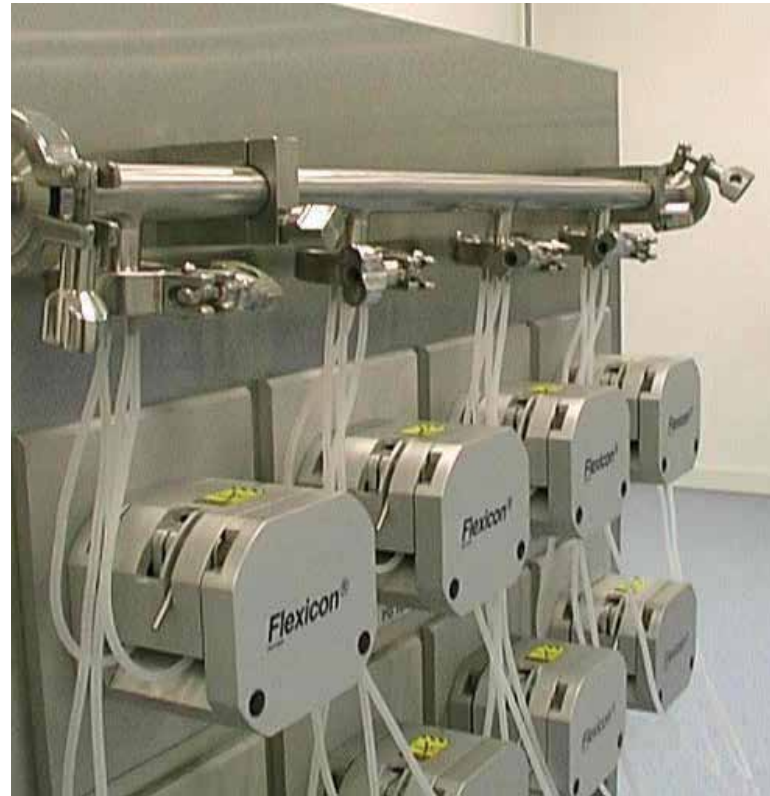
Trolleyløsninger leveres til integration i nye eller eksisterende fyldelinjer med op til seksten peristaltiske fyldeenheder
