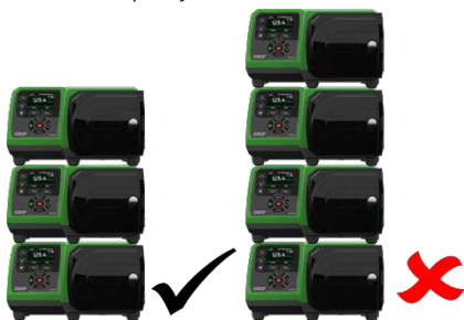
Figura 4 - Empilhamento de bombas
