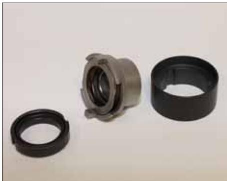
La cara estática con su junta tórica (izquierda) y el sello mecánico con una de sus juntas tóricas visible. Dos componentes que se muestran en la imagen deben entrar en contacto al realizar el montaje. Se puede ver el casquillo trasero visible, derecha
