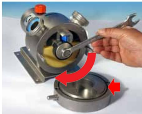
Es importante asegurarse de que el eje no pueda girar mientras se instala la tuerca del eje. Si es necesario, se puede inmovilizar cómodamente poniendo una llave de tuercas bien acolchada en el eje y la chaveta o el chavetero. Hay una herramienta de bloqueo del eje disponible de forma opcional, para abrir fácilmente el tornillo de retención: (SPS 100: TL-SP10-010-31).
