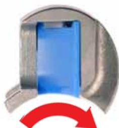
El peine y la guía del peine, orientados para la rotación en sentido horario del rotor
