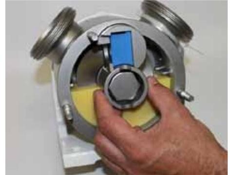
El soporte delantero puede separarse del eje con la cubierta delantera, como muestra la imagen (soporte de PEEK: imágenes superiores; soporte de acero inoxidable: imágenes inferiores), o puede permanecer en el eje. **Nota:** El soporte delantero de PEEK puede romperse.
