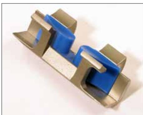
El peine y la guía del peine aparecen invertidos "cabezas abajo" en la imagen con el fin de mostrar claramente la posición del peine dentro de la guía para la rotación antihoraria del rotor.
