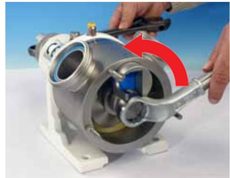
El tornillo de retención del eje
