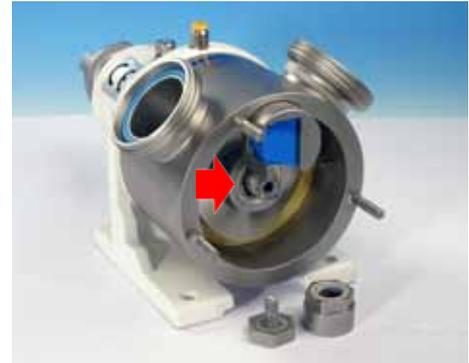
Es importante asegurarse de que el eje no pueda girar mientras se extrae la tuerca del eje. Si el motor está montado en la bomba, su par de torsión debería ser suficiente para inmovilizar el eje. Si no está inmovilizado, desacople la bomba del motor e inmovilice el eje con una llave tubular o con el mango de una llave de tuercas colocado entre las almenas del eje de accionamiento. Otra posibilidad es poner una llave de tuercas muy acolchada en el eje y la chaveta o el chavetero.
