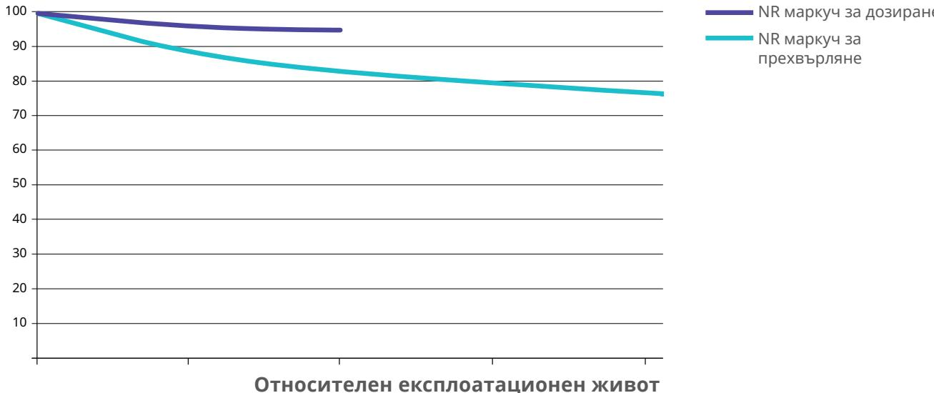
Типична производителност при тестови условия: изпомпване на вода при 18°C (64°F) с 5 бара (73 фунта на кв. инч) и 50 об./мин.
