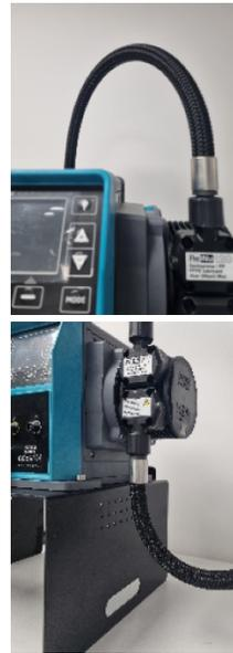
Überprüfen Sie die volle Länge und die Verlegung des Schlauchs und stellen Sie sicher, dass der Schlauch nicht verdreht oder geknickt ist, dass keine Schlauchstellen aneinander reiben (beispielsweise bei Windungen) und dass der Schlauch nicht an anderen Oberflächen reibt (beispielsweise an der Kante der Zugangsöffnung oder an der Stellfläche).
