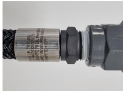
4. Überprüfen Sie, ob die Dichtung des Pumpenkopfanschlusses vorhanden und unbeschädigt ist, wie in der Abbildung gezeigt.
