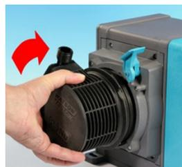
Um den Pumpenkopf vom Antrieb zu lösen, drehen Sie ihn etwa 15 ° im Uhrzeigersinn.
