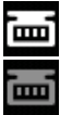
图 18 -屏幕信息栏中的白色图标表示 Mettler-Toledo ML-T 天平连接成功。屏幕信息栏中的灰色图标表示未经认证的兼容天平连接成功。
