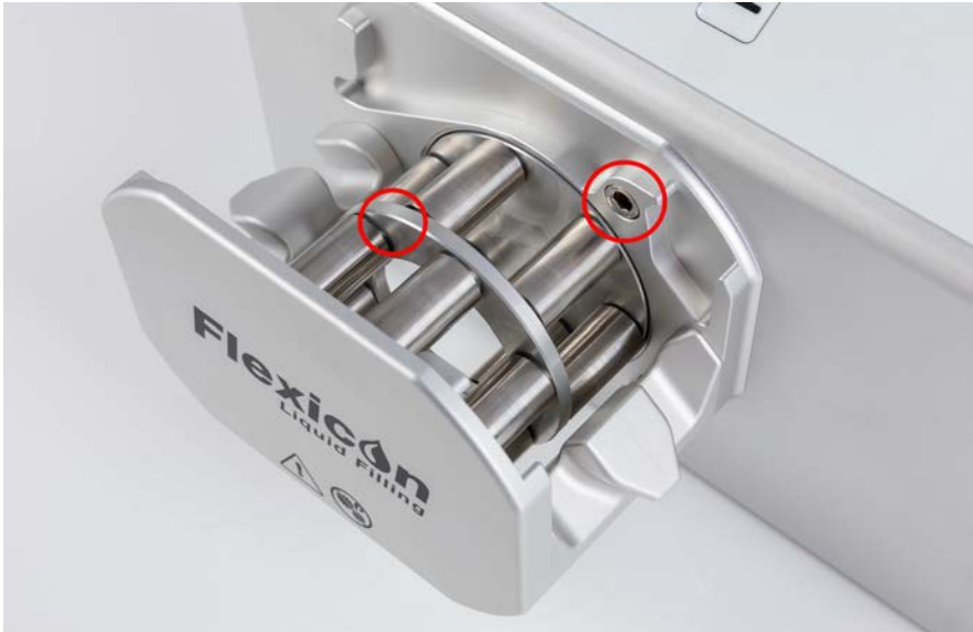
Figur 3 - Montering och borttagning av pumphuvudet
