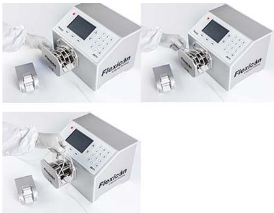
Figur 8 - Avlägsna slangen från pumphuvudet
