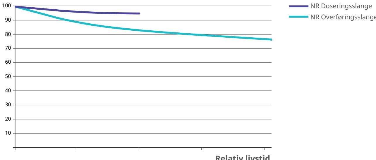
Typisk ytelse under testforhold: pumper vann ved 18 °C (64 °F) ved 5 bar (73 psi) og 50 opm
