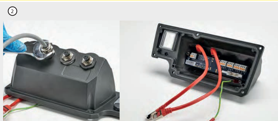
Figure 10 - Blindage à la terre des câbles de commande sur module NEMA EtherNet/IP™.
