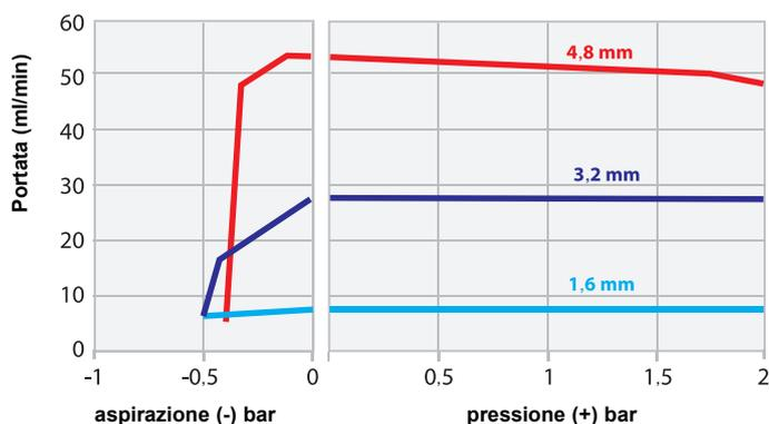
Portate ottenute pompando acqua a 100 giri/min con rotazione antioraria
