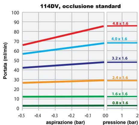
Portate ottenute pompando acqua a 100 giri/min con rotazione antioraria
