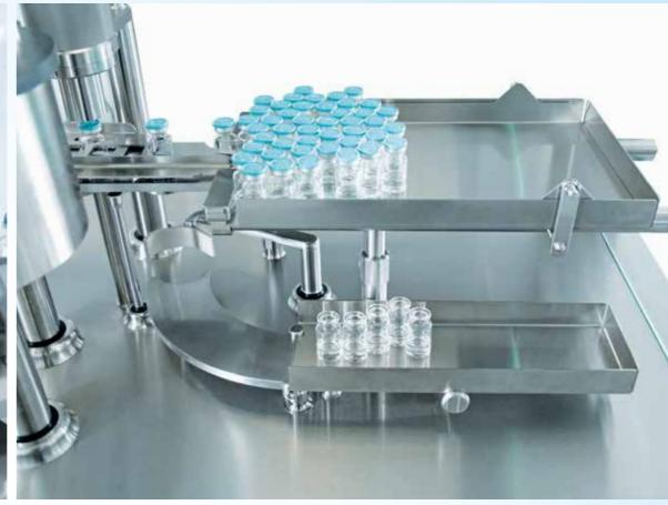
Wenn die FPC60 mit einer Inline-Gewichtskontrolle geliefert wird, verfügt sie über ein einzigartiges dynamisches Entlüften des Schlauchs bei der Chargeneinrichtung. Durch die dynamische Neukalibrierung ist kein Eingriff bei der Kalibrierung erforderlich, Produktverlust beim Start einer Charge wird verhindert. Weiterhin wird gewährleistet, dass jedes Vial, vom ersten bis zum letzten, gemäß den festgelegten Spezifikationen befüllt wird.
