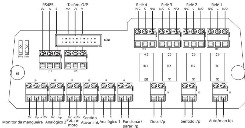
Cabo de controle recomendado: métrico = 0,14 mm<sup>2</sup> - 2,5 mm<sup>2</sup> sólido e 0,14 mm<sup>2</sup> - 1,5 mm<sup>2</sup> trançado. sistema USA = 26 AWG - 14 AWG sólido e 26 AWG - 16 AWG trançado. Cabo: circular. Diâmetro externo máx/mín que garanta vedação quando passado através do passa-cabos padrão: 9,5mm-5mm. **A seção do cabo deve ser circular, para assegurar a vedação.**
