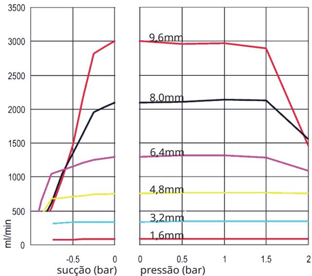
**Mangueiras contínuas em Marprene, parede de 2,4 mm, 200 rpm, rotação em sentido anti-horário**
