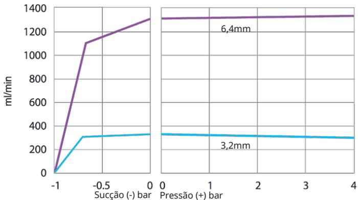
**Elemento Sta-Pure, 2-4 bar, 200 rpm, rotação em sentido anti-horário**
