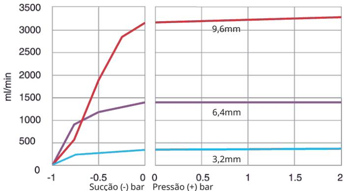
**Elemento TM em Marprene, 2-4 bar, 200 rpm, rotação em sentido anti-horário**
