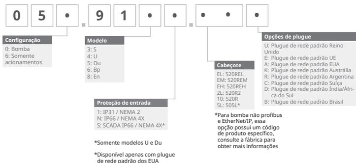
\*Módulo NEMA especial 059.911.F.100 Módulo à prova d'água Ethernet (530F) IP66 NEMA 4X é necessário para o sensor de vazão KROHNE, combinado com bomba de proteção IP31
