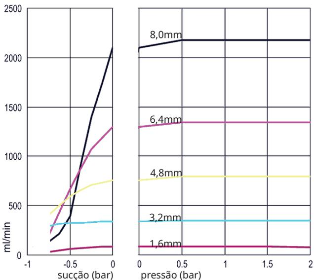
**Mangueiras contínuas em Marprene, parede de 2,4 mm, 200 rpm, rotação em sentido horário**
