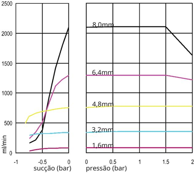
**Mangueiras contínuas em Marprene, parede de 1,6mm, 200 rpm, rotação em sentido anti-horário**
