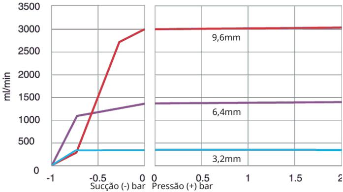
**Elemento Sta-Pure, 0-2 bar, 200 rpm, rotação em sentido anti-horário**
