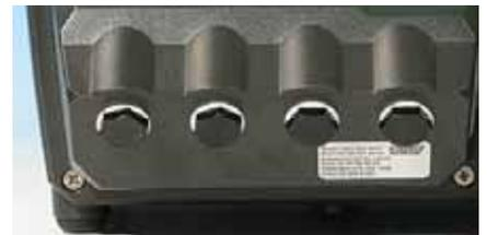
Empfohlene Steuerkabel müssen für die Klemmenblöcke benutzt werden: metrisch = 0,14-2,5 mm<sup>2</sup> (massiv) und 0,14-1,5 mm<sup>2</sup> (Litze). USA = 26 AWG – 14 AWG (massiv) und 26 AWG – 16 AWG (Litze). Kabel: rund. Maximaler und minimaler Außendurchmesser, um nach der Durchführung durch die Standardkabelverschraubung eine gute Abdichtung zu gewährleisten: 9,5 mm – 5 mm. **Der Kabelquerschnitt muss rund sein, um eine gute Abdichtung zu gewährleisten.**
