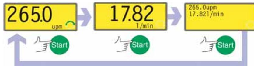
Falls die Pumpe läuft, wenn die Taste **START** gedrückt wird, wechseln die Angaben im Handbedienungs-Hauptbildschirm von Umdrehungen pro Minute zu Fördermenge in Millilitern pro Minute (mit einem Warnbildschirm, falls die Fördermenge nicht kalibriert wurde und dies der erste Arbeitszyklus seit dem Einschalten ist) und schließlich zu U/min und Fördermenge. (Siehe Beispiel.)
