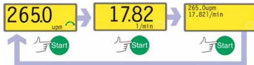
Falls die Pumpe läuft, wenn die Taste **START** gedrückt wird, wechseln die Angaben im Handbedienungs-Hauptbildschirm von Umdrehungen pro Minute zu Fördermenge in verschiedenen Maßeinheiten (mit einem Warnbildschirm, falls die Fördermenge nicht kalibriert wurde und dies der erste Arbeitszyklus seit dem Einschalten ist) und schließlich zu Umdrehungen, Fördermenge und Laufzeit. (Siehe Beispiel.) Die Standardeinstellung kann über das Setupmenü (siehe 16.3 Anzeige) geändert werden.
