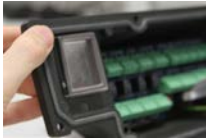
GF: 图 5 - 电压选择开关
