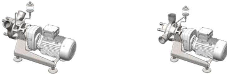
Remova o bujão rosqueado da devida abertura de lavagem usando um soquete de 10 mm com extensão.
