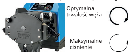
rys. 3 - Kierunek wirnika
