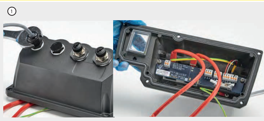
rys. 10 - Ekranowanie uziemienia przewodów sterowania wEtherNet/IP™ module NEMA
