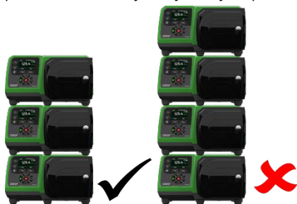
rys. 2 - Układanie pomp w stos
