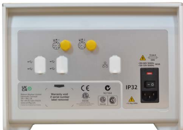
Figura 15 - Il retro della pompa. L'immagine mostra la pompa PF7+. Il pannello dell'unità PF7 è leggermente diverso. I connettori M12 si trovano nello stesso punto.
