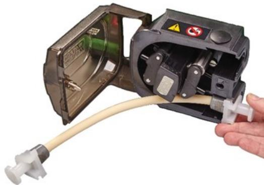
5. Disinnestare la frizione del rotore premendo a fondo il tasto della frizione giallo sul lato del mozzo e ruotare il mozzo di alcuni gradi tenendo premuto il tasto della frizione. A questo punto il rotore può ruotare indipendentemente dal riduttore e dal motore per un giro completo. Se la frizione si reinnesta prima che sia stato completato il caricamento del tubo, premere di nuovo il tasto e ruotare il rotore di alcuni gradi.
