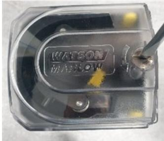
3. Aprire completamente il coperchio per creare il massimo spazio per gli attacchi del tubo.
