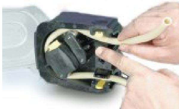
18. Controllare che i morsetti per tubo a molla afferrino il tubo abbastanza saldamente da evitare che si sposti nella testina ma non troppo da stringerlo eccessivamente. Regolare i cursori in modo da evitare lo spostamento del tubo durante le rotazioni di prova del rotore. La posizione esterna consente ai morsetti di afferrare saldamente il tubo, mentre la posizione interna consente loro di afferrare il tubo in modo lasco.
