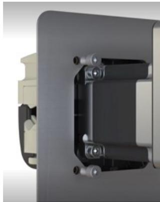
5. Serrare in modo alternato i 4 bulloni di montaggio a 4,6 Nm.
