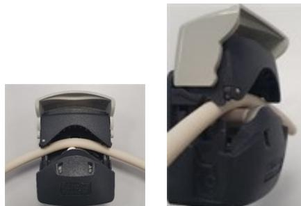
8. Abbassare il coperchio flip top nella posizione completamente chiusa, in questo modo il tubo verrà messo automaticamente in tensione in modo corretto.
