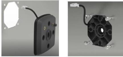
3. Controllare che il cavo del sensore coperchio aperto integrato non sia incastrato o tocchi il bordo dell'apertura.
