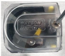
3. Rimuovere il mozzo del rotore sollevando il coperchio antipolvere e rimuovendo il fermo di fissaggio.
