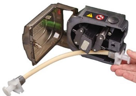
7. Disinnestare la frizione del rotore premendo a fondo il tasto della frizione giallo sul lato del mozzo e ruotare il mozzo di alcuni gradi tenendo premuto il tasto della frizione. A questo punto il rotore può ruotare indipendentemente dal riduttore e dal motore per un giro completo. Se la frizione si reinnesta prima che sia stato completato il caricamento del tubo, premere di nuovo il tasto e ruotare il rotore di alcuni gradi.
