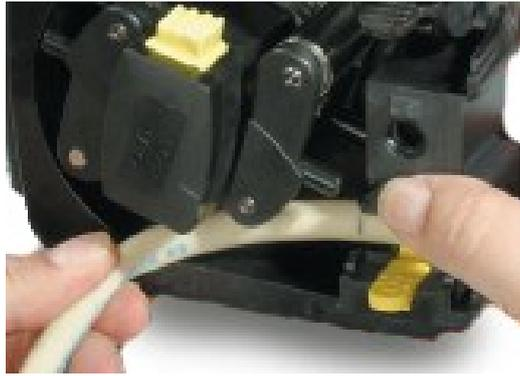
17. Verificare che il secondo contrassegno dei 225 mm sia adiacente al bordo interno del morsetto per tubo superiore. Aprire il fermaglio a molla superiore del tubo e posizionarvi il tubo, verificando che il tubo non sia contorto e che risulti in posizione centrale tra i rulli di guida. Rilasciare il fermaglio.
