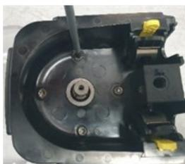
7. Fissare il mozzo del rotore sollevando il coperchio antipolvere e inserendo il fermo di fissaggio.
