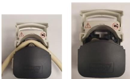
8. Abbassare il coperchio flip top nella posizione completamente chiusa, in questo modo il tubo verrà messo in tensione automaticamente in modo corretto. Controllare che il tubo si trovi nella posizione mostrata. Non mettere in tensione ulteriormente il tubo.
