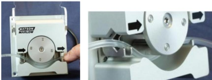
8. Abbassare il coperchio flip top nella posizione completamente chiusa, in questo modo il tubo verrà messo in tensione automaticamente in modo corretto.
