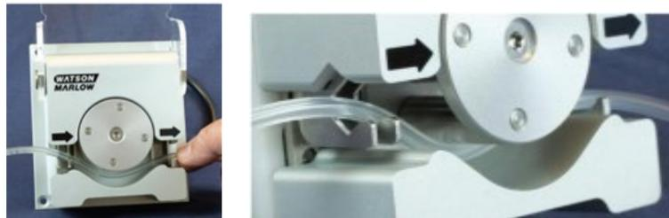
6. Abbassare il coperchio flip top nella posizione completamente chiusa, in questo modo il tubo verrà messo in tensione automaticamente in modo corretto.
