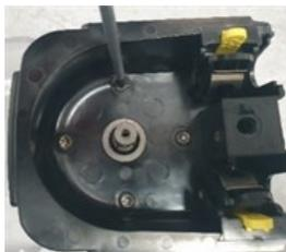
5. Rimuovere la testa dalla piastra di montaggio e sostituire con la nuova testa.
