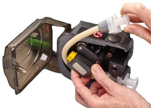
7. Posizionare l'estremità connettore opposta dell'elemento nell'alloggiamento superiore. Accertarsi che l'elemento non sia attorcigliato e poggi al centro tra i rulli.
