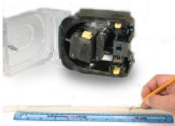
5. Aprire il morsetto per tubo a molla inferiore e posizionarvi il tubo, con il primo contrassegno dei 225 mm allineato con la superficie interna della parte a molla del morsetto per tubo. Rilasciare il fermaglio.
