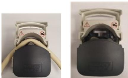
6. Abbassare il coperchio flip top nella posizione completamente chiusa, in questo modo il tubo verrà messo in tensione automaticamente in modo corretto.
