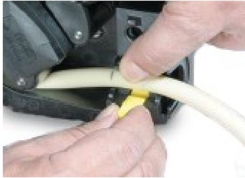
6. Disinnestare la frizione del rotore premendo a fondo il tasto della frizione giallo sul lato del mozzo e ruotare il mozzo di alcuni gradi tenendo premuto il tasto della frizione. A questo punto il rotore può ruotare indipendentemente dal riduttore e dal motore per un giro completo. Se la frizione si reinnesta prima che sia stato completato il caricamento del tubo, premere di nuovo il tasto e ruotare il rotore di alcuni gradi.
