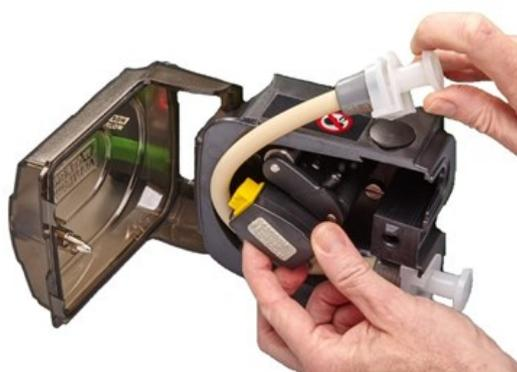
9. Posizionare l'estremità connettore opposta dell'elemento nell'alloggiamento superiore. Accertarsi che l'elemento non sia attorcigliato e poggi al centro tra i rulli.
