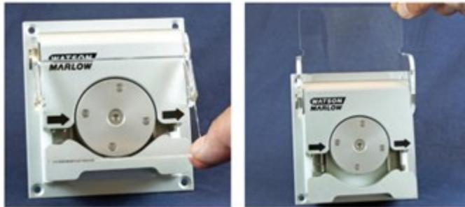
5. Assicurarsi che sia installata la dimensione del tubo corretta per i morsetti per tubo.
