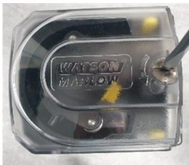
5. Aprire completamente il coperchio per creare il massimo spazio per gli attacchi del tubo.
