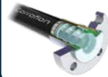
O revestimento interno em PTFE nas mangueiras Corroflon apresenta convoluções pouco profundas que minimizam as restrições dos caudais, bem como um fio de reforço externo nas convoluções externas que proporciona uma resistência total ao vácuo e a dobras
