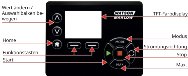
Figure 4 - Layout des Tastenfelds und Tasten-IDs
